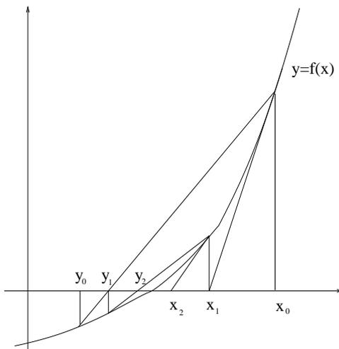
Figura 1.8: Illustrazione grafica del metodo di Newton
