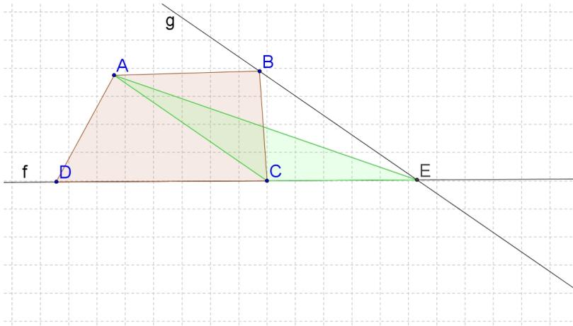
**Costruzione 14.** *Costruire un triangolo di data base ed equivalente a un triangolo dato.*
