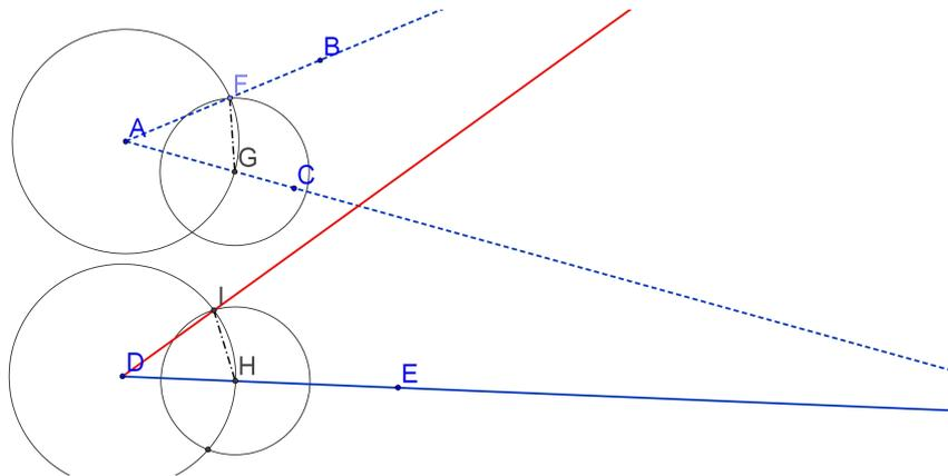
**Costruzione 6.** Dato una retta e un punto esterno ad essa, condurre la parallela alla retta passante per il punto.
