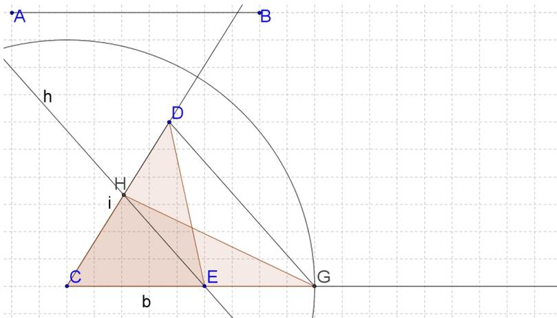
**Costruzione 15.** *Costruire un triangolo di data altezza ed equivalente a un triangolo dato.*
