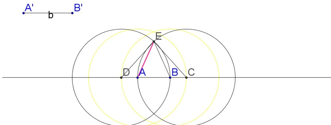
**Costruzione 8.** *Dividere il segmento in sezione aurea (ossia in due parti tale che il quadrato della parte maggiore sia equivalente al rettangolo dell'intero segmento e della parte minore)*
